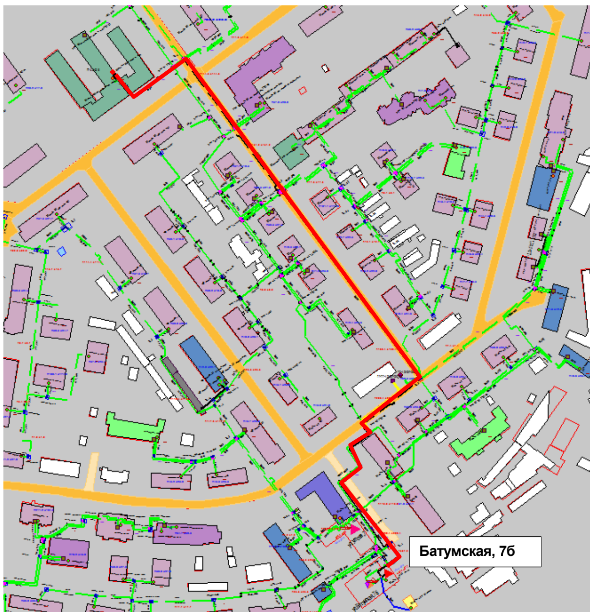
Рисунок Ошибка! Текст указанного стиля в документе отсутствует..157 – Результат гидравлического расчета - расчетный путь теплоносителя от котельной Батумская, 76 до ПТ-ПП-2.94-2016
