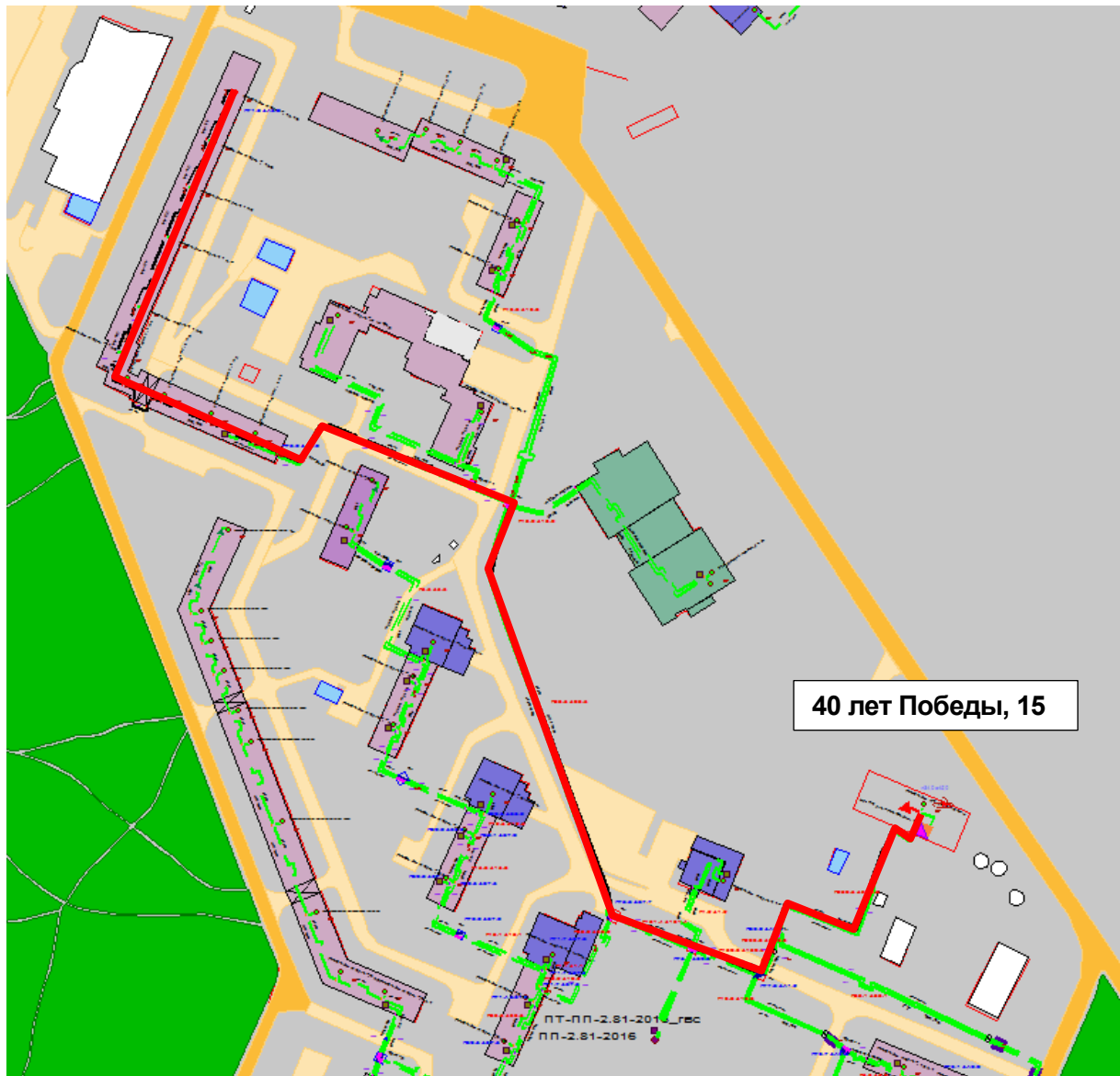
Рисунок Ошибка! Текст указанного стиля в документе отсутствует..203 – Результат гидравлического расчета - расчетный путь теплоносителя от котельной 40 лет Победы, д.15 до ПТ-Победы 40лет,1 з10
