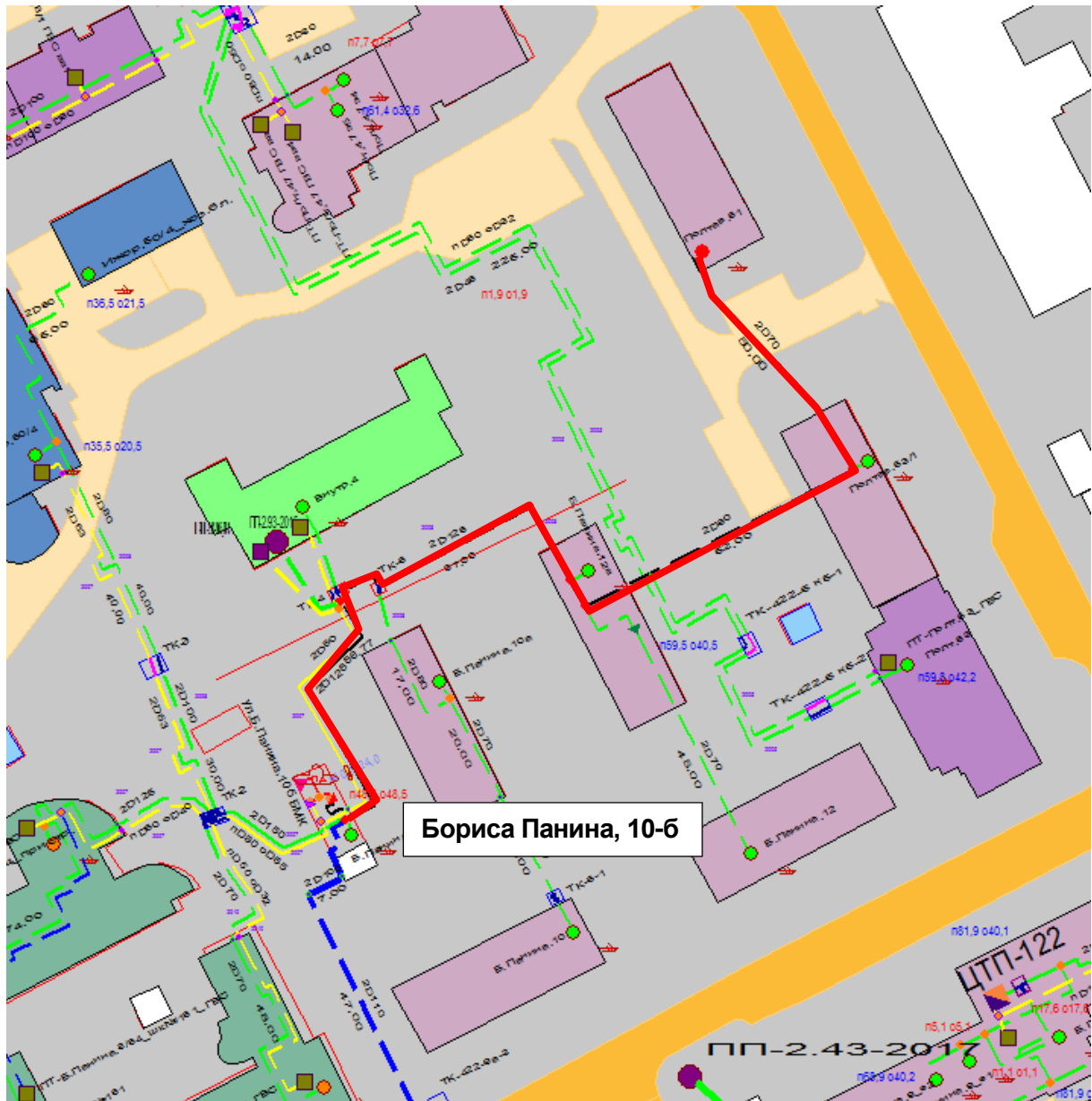
Рисунок Ошибка! Текст указанного стиля в документе отсутствует..177 – Результат гидравлического расчета - расчетный путь теплоносителя от котельной Бориса Панина, 10-б до ПТ-Полтав,51
